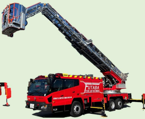
大型高所放水車
